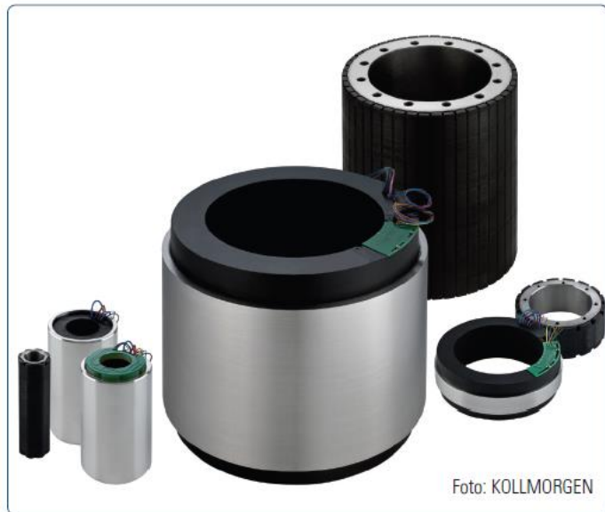
Gehäuselose Direktantriebe – hier die Baureihe KBM – lassen sich konstruktiv nicht direkt mit dezentralen Servoreglern als „Huckepack“-Lösung verbinden. Regler in unmittelbarer Nähe erschließen dann die Vorteile dezentraler Architekturen UND der Direktantriebstechnik.
